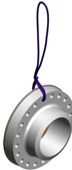
Typisk løfting av flens - løfteslings gjennom bolthull
